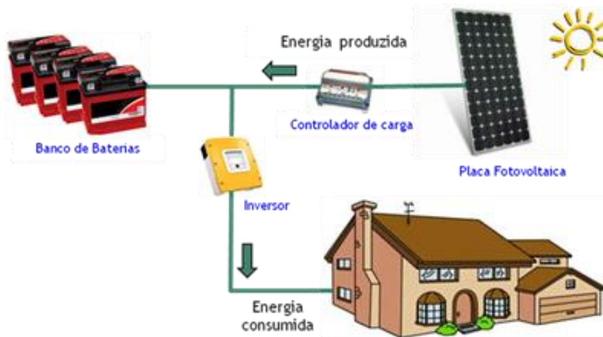
Imagen 12. Componentes de un sistema fotovoltaico
