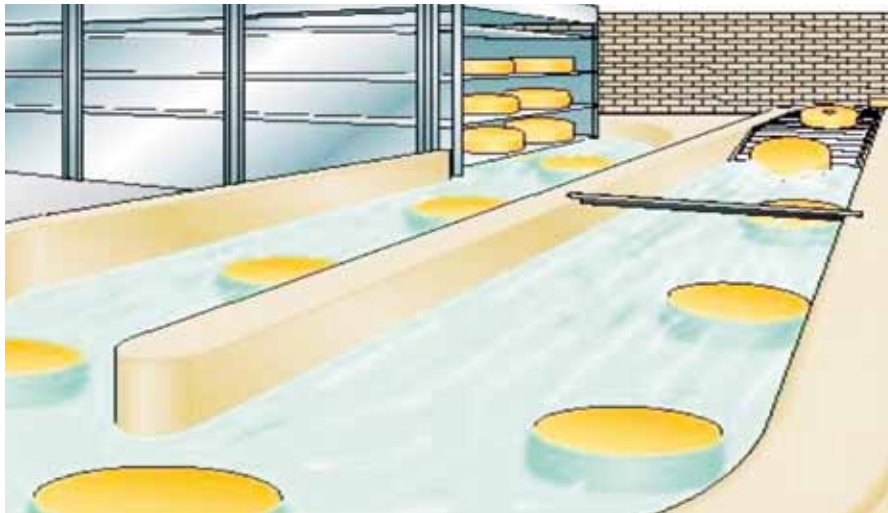
Figura 6. Proceso de salado y moldeo (FOOD-INFO, 2009)
