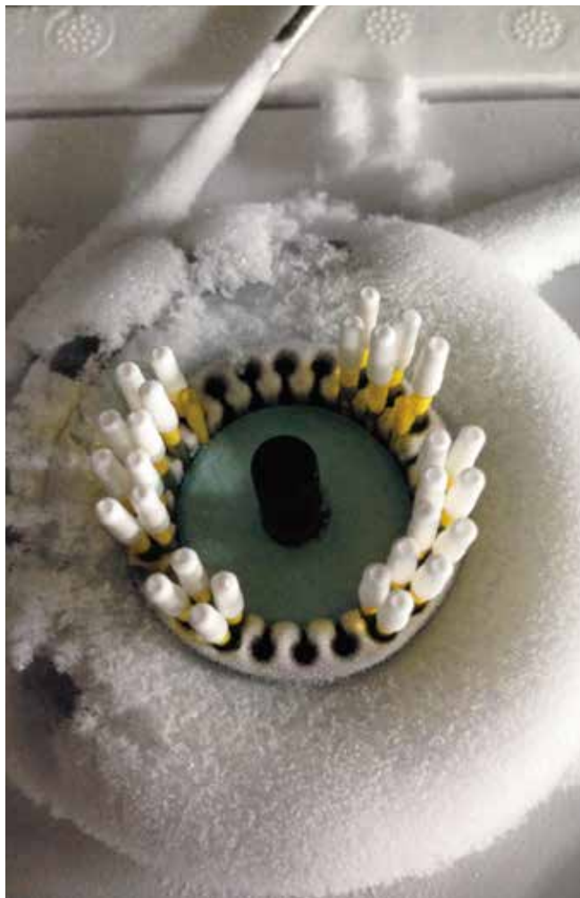
Figura 5. Embriones empajillados en cubeta de máquina de congelamiento de embriones, listos para pasarlos a los goblets y guardarlos en el termo con nitrógeno líquido.
