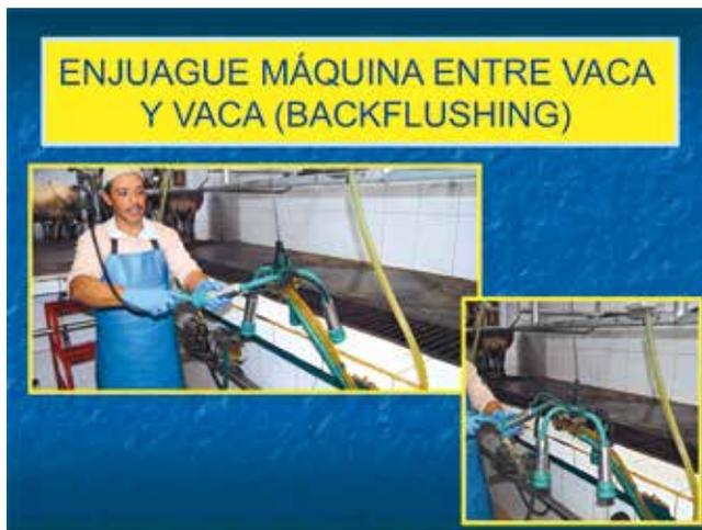
**Figura 15.** Enjuague de la máquina "backflush" con vacío cortado entre vaca y vaca (Lêvesque, 2004).
