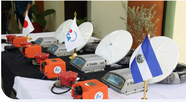
El equipo proporcionado por la cooperación japonesa consiste en receptores GNSS, geófonos de alta sensibilidad, tecnología DAS (Distributed Acoustic Sensing), y un OBS (Ocean Bottom Seismometer).
